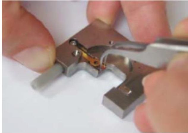
Şekil 5.18 SiN tipin Atomik Kuvvet Mikroskobu tutucu mekanizmasına yerleştirilmesi
