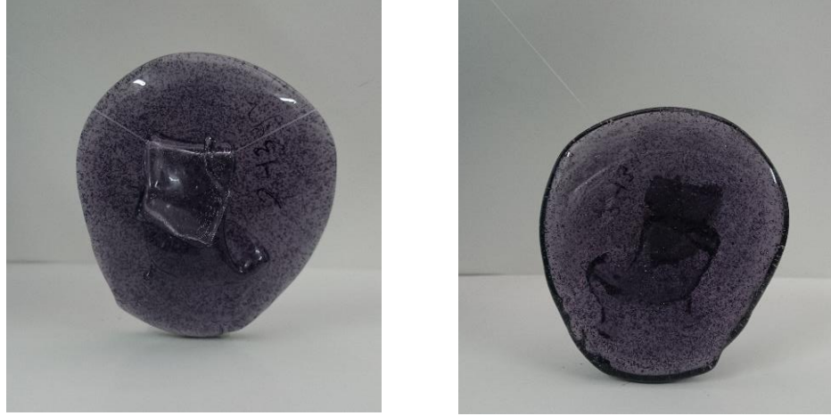
Görsel 5.13. 1200°C'de döküm yapılan mor cam (%5 MnO 2 )
