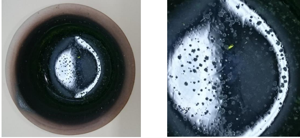
Görsel 4.16. 1150°C'de ve %3 numunede oluşan kristaller.
