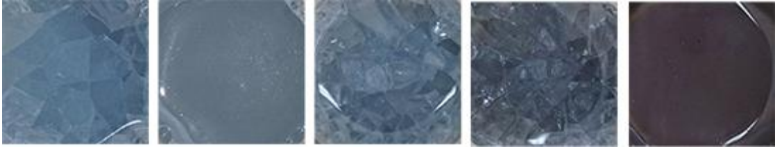
Görsel 4.10. 1150°C’de manganez(IV) dioksit ( MnO_2 ) kullanarak üretilen mor camlar. Sırayla soldan: %0.1, %0.3, %0.5, %1 ve %3.
