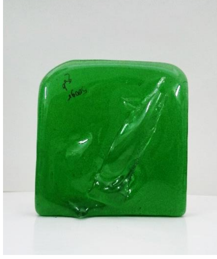
Görsel 5.11. 1200°C'de döküm yapılan çim yeşili renkli cam (%0.1 Cr 2 O 3 )
