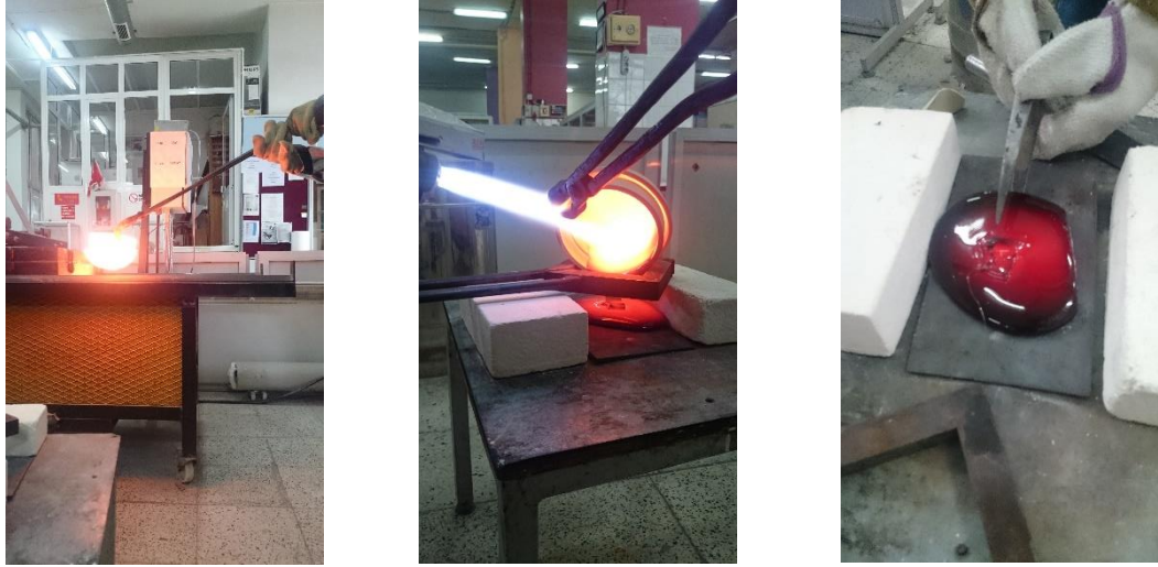
Görsel 4.6. Sıcak cam döküm aşamaları
