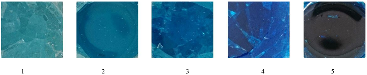
Görsel 4.28. 1150^\circ\text{C} 'de Bakır(II) oksit ( \text{CuO} ) kullanarak üretilen turkuaz camlar.
