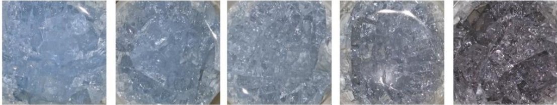
Görsel 4.11. 1200°C’de manganez (IV) dioksit ( MnO_2 ) kullanarak üretilen mor camlar. Sırayla soldan: %0.1, %0.3, %0.5, %1 ve %3.
