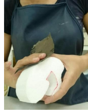
Görsel 5.3. Strafor kesme cihazında model kesimi ve model zımparalaması
