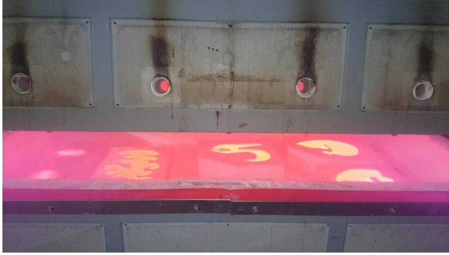
Görsel 5.15. maksimum sıcaklıkta fırının aşamalı soğutulması
