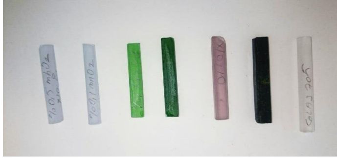
Görsel 4.8. Dilatometre analizi için hazırlanan çubuk örnekleri
