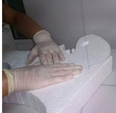
Görsel 5.3. Strafor kesme cihazında model kesimi ve model zımparalaması
