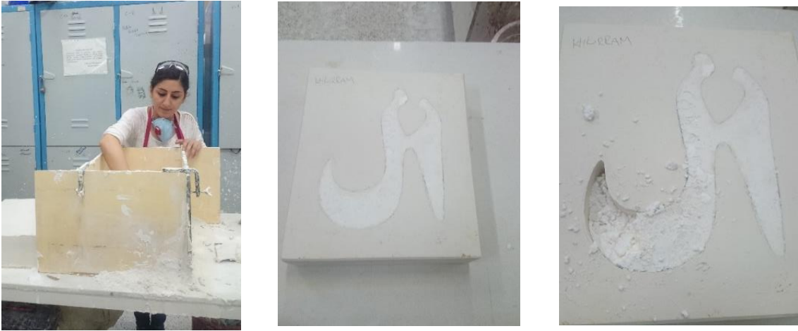
Görsel 5.6. Alçı kalıp hazırlanması ve straforların kalıptan çıkarılması
