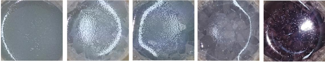
Görsel 4.9. 1100° C’de manganez(IV) dioksit ( MnO_2 ) kullanarak üretilen mor camlar. Sırayla soldan: %0.1, %0.3, %0.5, %1 ve %3.
