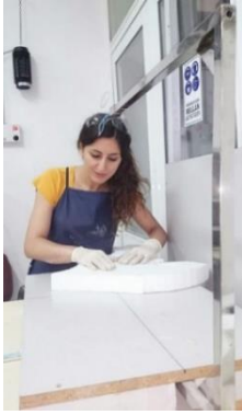
Görsel 5.3. Strafor kesme cihazında model kesimi ve model zımparalaması
