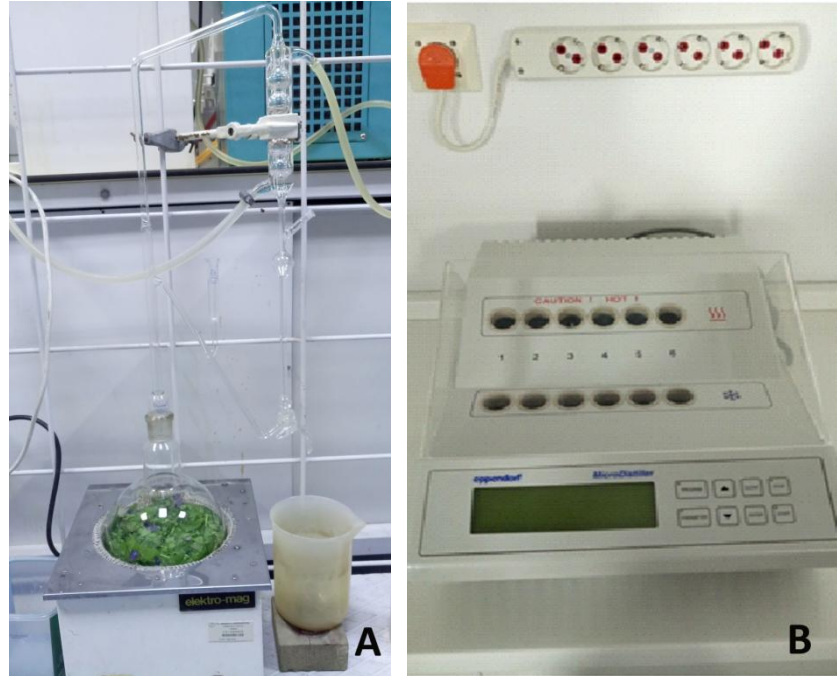
Görsel 3.1. A- Clevenger apareyi, B- Mikrodistilasyon cihazı
