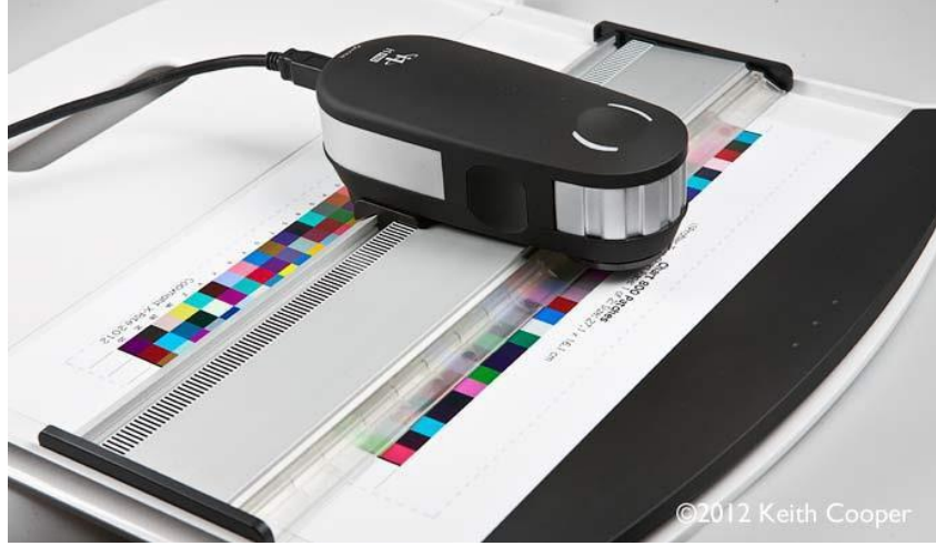
Görsel 4.38. i1Pro ile renk okutma işlemi
