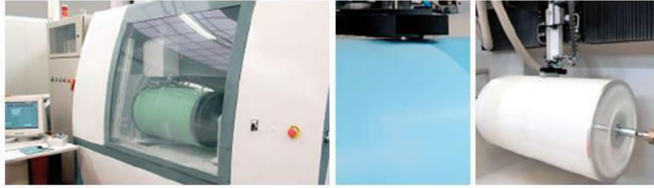
Görsel 4.20. Farklı tip ve özelliklerde rotatif eleğe desen işleyebilen lazer işleme makinesi Kaynak: Özkan, 2017, s.40
