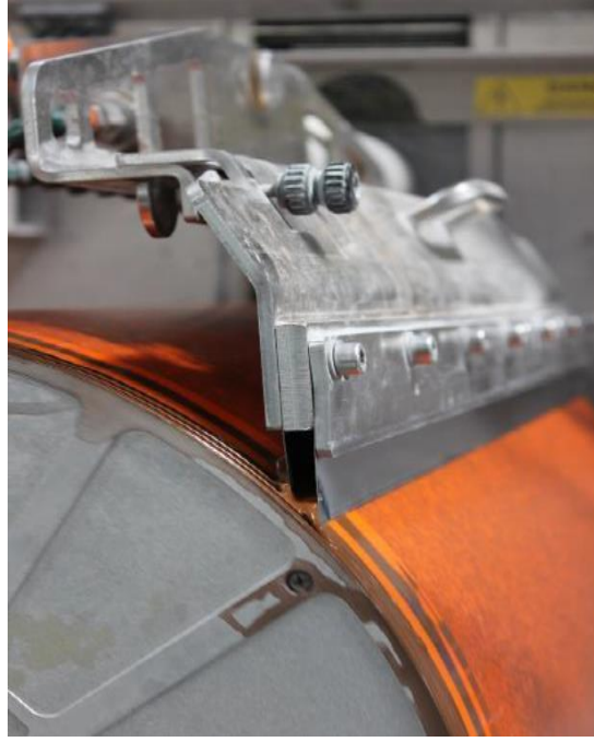
Görsel 4.21. Rotocolor ekte, baskı makinesinde bıçağın elek yüzeyindeki konumu Kaynak: Özkan, 2017, s.41
