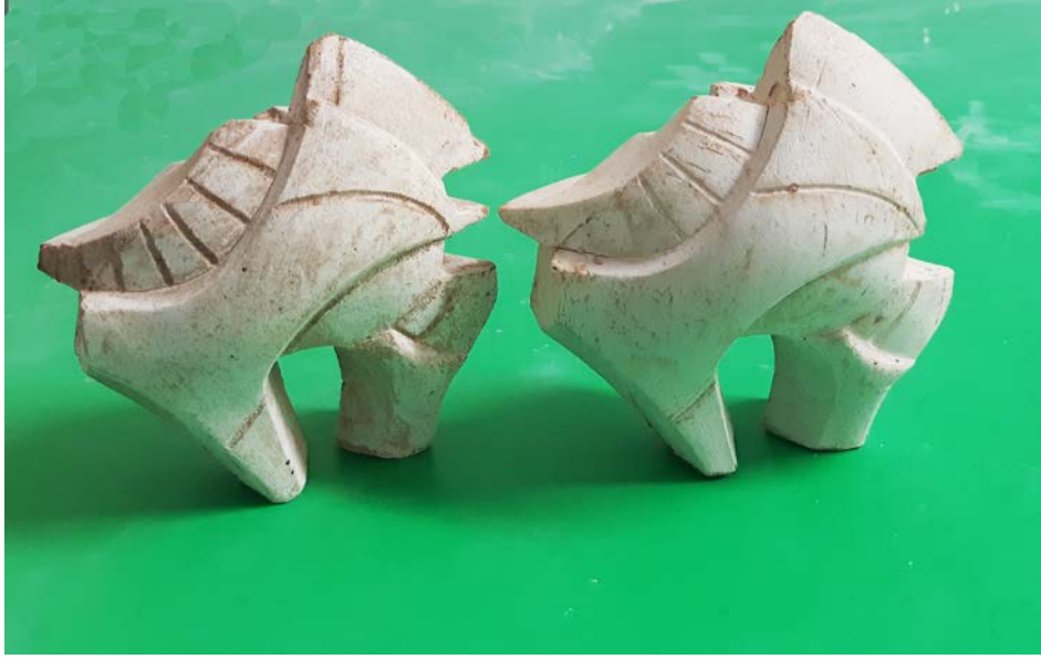
Görsel 3.7. Isıl işlem sonrası AC-GP karışımıyla oluşturulmuş "Model A" formu (Filiz, 2022)
