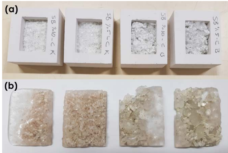
Görsel 3.35. (a) Fırınlama işlemi öncesi, (b) Fırınlama işlemi sonrası görüntüsü (Filiz, 2022)
