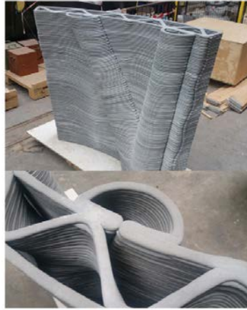
Görsel 1.4. Ekstrüzyon yöntemiyle şekillendirilmiş beton yapı parçası (Gosselin, 2016)
