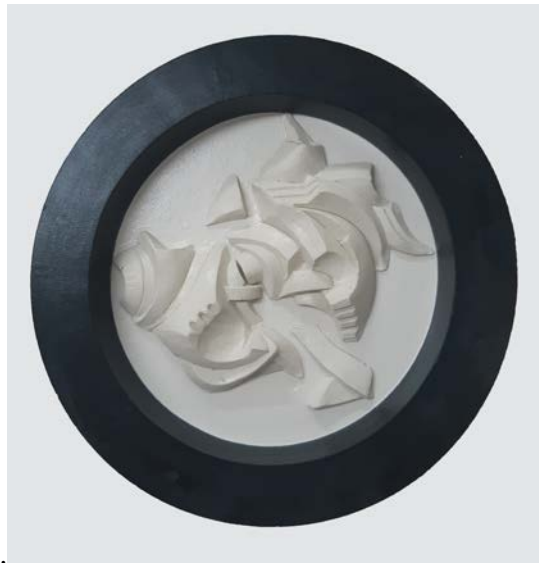
Görsel 3.32 %30AC - %70 GP katkılı karışım kullanılarak hazırlanan kalıp (Filiz, 2022)
