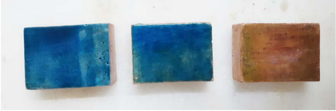
Görsel 3.9. Raku sırla sırlanarak 900 °C sıcaklıkta pişirilmiş numuneler (Filiz, 2022)
