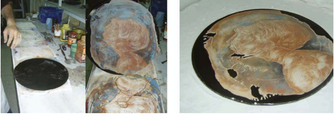
Görsel 2.26. Solda döküm sonrası bekleme ve cam plakayı alçı yüzeyden ayırma, sağda ise füzyon işlemi için fırına yerleştirme işlemleri (Ağatekin, 2009).
