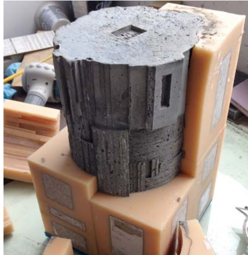
Görsel 1.3. David Umemoto, Brutalist beton uygulama süreci; döküm ve kalıptan çıkarma 1
