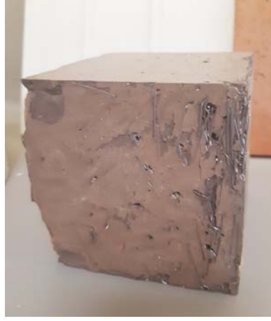
Görsel 1.2. ÇİMSA tarafından üretilen balistik beton uygulaması (Filiz, 2019)
