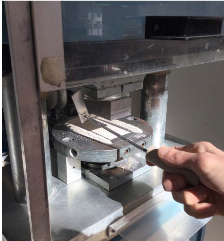
Görsel 3.3. 200 \text{ kg/cm}^2 pres basıncı ile preslenen toz numune (Filiz, 2022)
