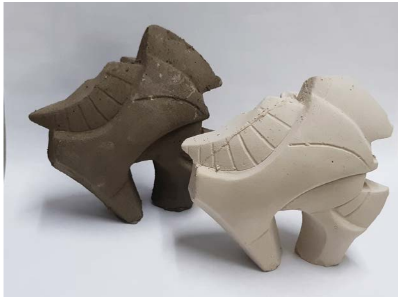
Görsel 3.6. Silikon kalıptan çıkartılan “Model A” solda AC, sağda SB karışımları (Filiz, 2022)
