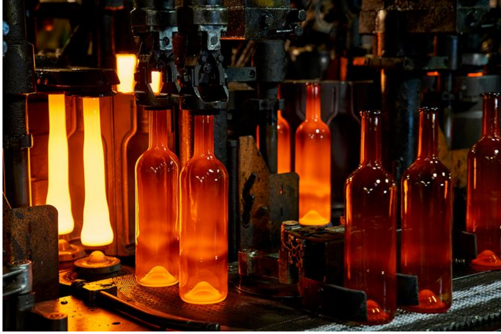
Görsel 2.25. Arkada üfleme kalıbı kapanmadan hemen öncesi, önde ise üflemeden çıkmış ürünler 37
