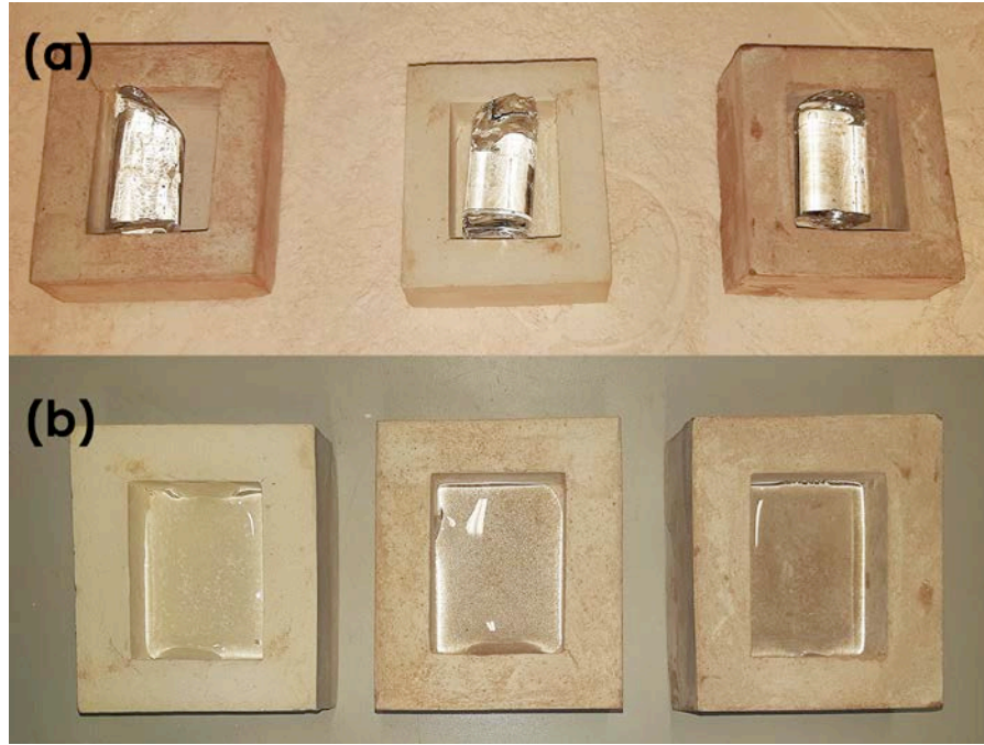
Görsel 3.30. (a) ısıtım işlem öncesi AC-GP karışımıyla hazırlanan kalıp içerisindeki rod cam görüntüsü, (b) ısıtım işlem sonrası AC-GP karışımıyla hazırlanan kalıp içerisindeki rod cam görüntüsü (Filiz, 2020)
