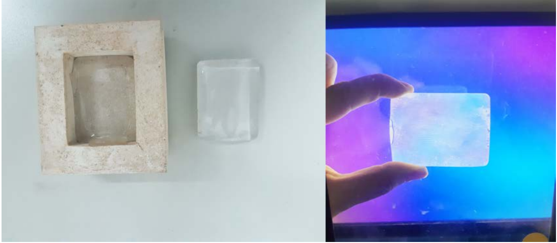
Görsel 3.31. Polariskopla gerilim analizi gözlemi (Filiz, 2022)
