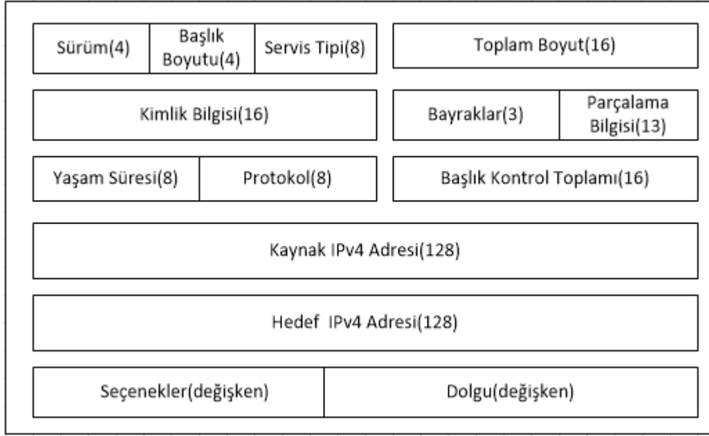
Şekil 2.1. Ipv4 Başlık Yapısı
