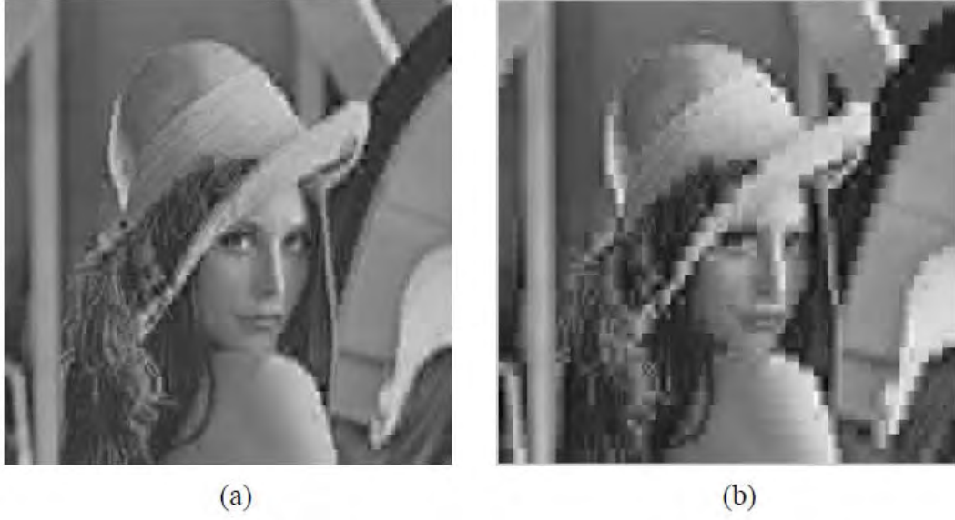
Şekil 2.4. "Lena" imgesinin (a) 4 katsayı (%6,25), 30,62 dB; (b) 2 katsayı (%3,125), 26,97 dB ile geri çatılması.
