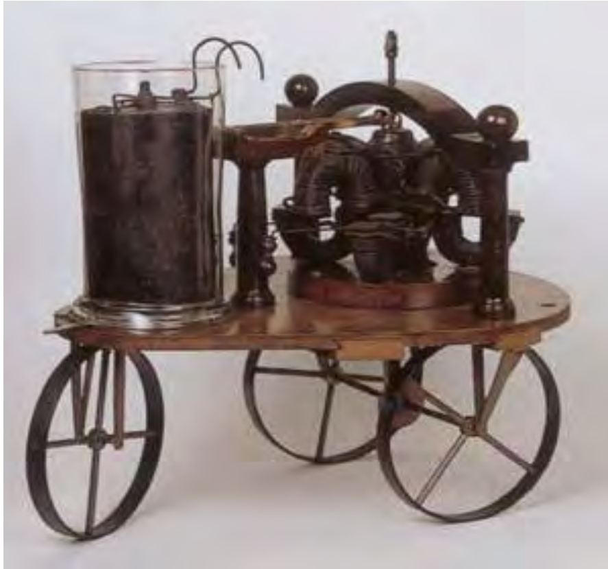
Şekil 3.2. Sibrandus Stratingh tarafından yapılan, elektrik ile çalışan ilk araç ( http://21 ).
