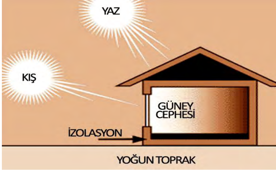
Şekil 2.3. Pasif Güneş Sistemi İçin Şematik Konumlandırma (http 9)
