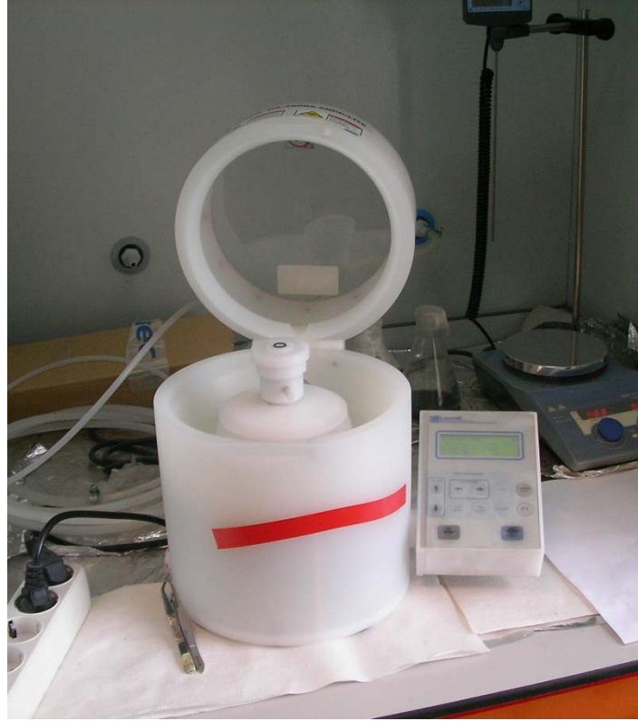
Şekil 3.1. Döndürerek kaplama yöntemi deney düzeneği
