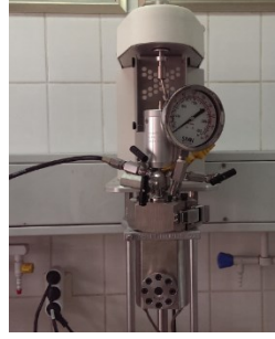
Şekil 3.62. Katalitik tepkimelerin gerçekleştirildiği reaktör (Parr 4848)
