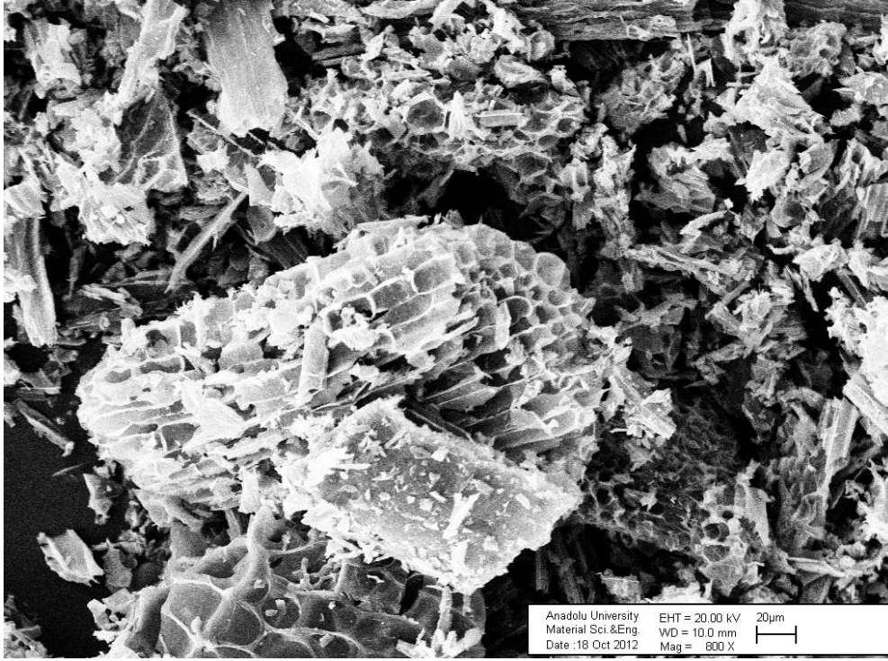
Şekil 9.26. Biyokütlenin 500 °C sıcaklık, 450 °C/dk ısıtma hızı ve 1 bar basınçta gerçekleştirilen pirolizinden elde edilen charın SEM görüntüsü
