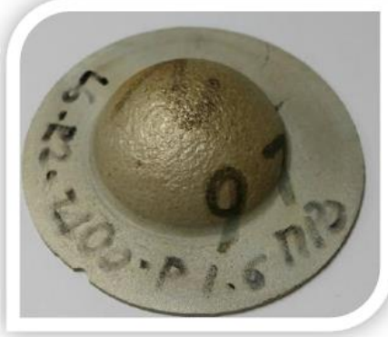
Şekil 3.12. 400 °C'de Mg-2Zn-2Ce alaşımı serbest şişme numunesi.
