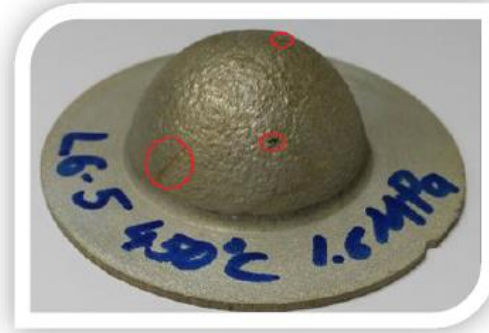
Şekil 3.14. 450 °C'de Mg-2Zn-2Ce alaşımı serbest şişme numuneleri (ilk testler).
