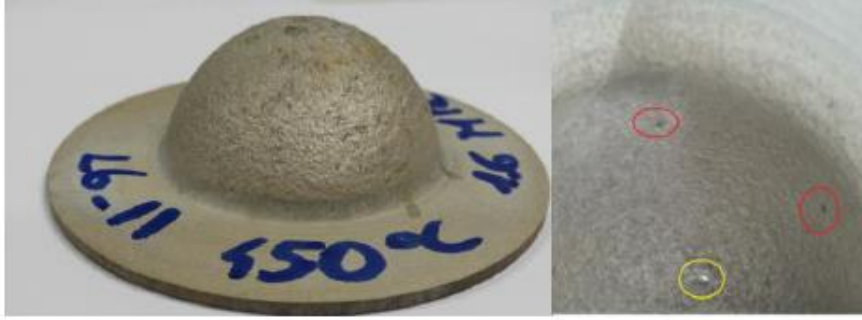
Şekil 3.15. 450 °C'de Mg-2Zn-2Ce alaşımı serbest şişme numuneleri (ikinci testler).
