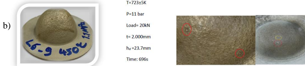
Şekil 3.17. Mg-2Zn-2Ce alaşımı üzerinde farklı koşullarda ilaveten yapılan serbest şişme testleri sonuçları. (a) İlk ilave test; (b) ikinci ilave test.
