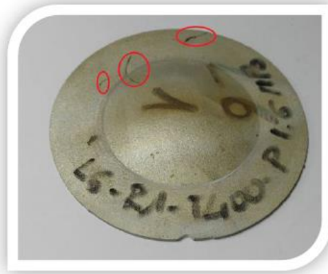
Őekil 3.11. 400 °C'de Mg-2Zn-2Ce alařımı serbest ŐiŐme numunesi.
