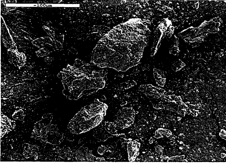
Şekil 5.17. (G) kodlu kil esaslı hammaddeye ait temsili SEM (SEI) görüntüsü
