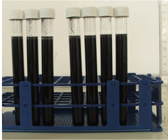
Şekil 3.5. Ağırlıkça %1-%2.5 STPP bulunan sedimentasyon test düzeneği
