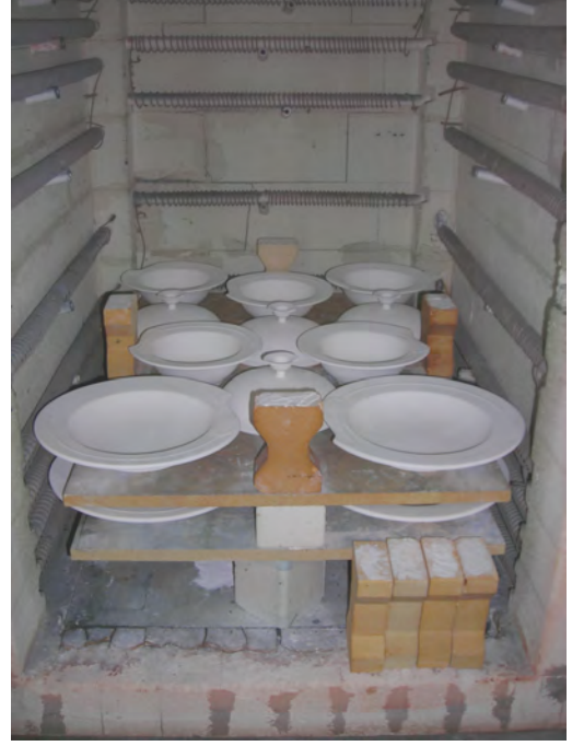
Resim 76b. Raflar arasında gerekli boşluk bırakılarak fırın içi ısı sirkülasyonu sağlanmaktadır.
