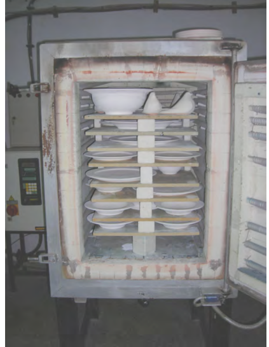
Resim 76d. Sırlı parçaların yerleştirilmesi tamamlandıktan sonra istenilen pişirim derecesi için uygun pişirim programı seçilir.
