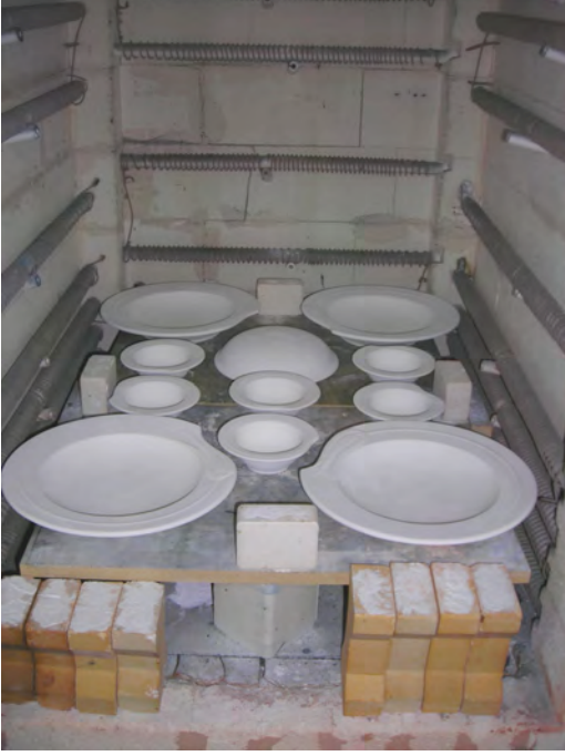
Resim 76a. Uygun sırlama yöntemi ile sırlanan yemek takımının tüm parçaları fırına yerleştirilmektedir.
