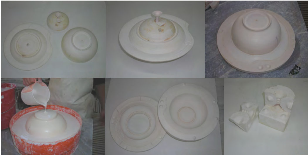
Resim 74. Dolu-boş döküm yöntemi ile üretilecek parçanın model yapımı ve kalıp alma
