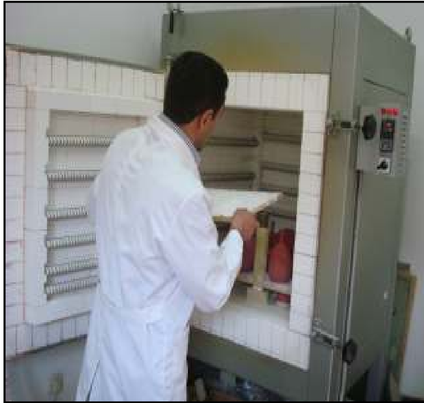
Resim 46. Temmoku Sırların Pişiriminde Kullanılan Elektrikli Kamara Fırın
