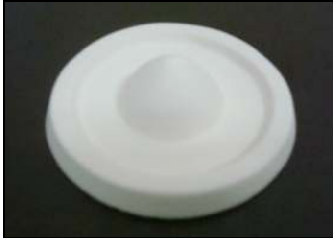
Resim 39. Sır Arařtırmalarında Kullanılan Deney Plakası
