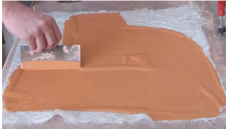
Resim 121. Sır Katkılı Karışımın Cam Elyafa Dökülmesi (Fotoğraf: Orçun Aksakal)
