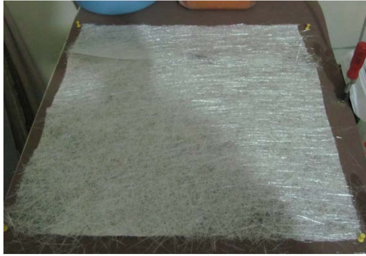
Resim 120. Düz Bir Yüze Serilmiş Cam Elyaf Parçası (Fotoğraf: Orçun Aksakal)
