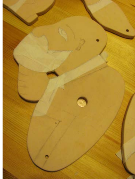
Resim 131. Sırlanmak üzere şablonları hazırlanmış bisküvi parçalar (Hacivat-Karagöz) (Fotoğraf: Orçun Aksakal)
