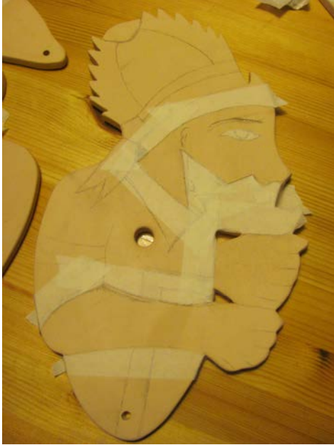
Resim 131. Sırlanmak üzere şablonları hazırlanmış bisküvi parçalar (Hacivat-Karagöz) (Fotoğraf: Orçun Aksakal)
