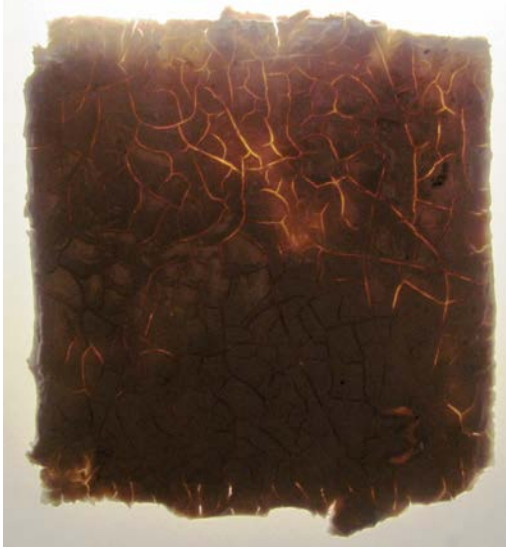
Resim 102. Üç kez çamura batırılmış parça (alt kısım sırlı)
