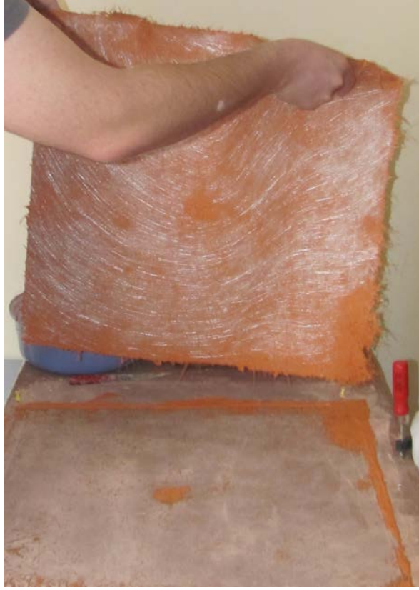
Resim 122. Cam Elyaf Parçanın Ters Çevrilmesi (Fotoğraf: Orçun Aksakal)
