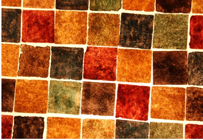
Resim 125. Işıklı pano üzerinde çeşitli renklerde sırlanmış cam elyaf katkılı porselen karolar 8 x 8 cm, 1040°C (Fotoğraf: Uğur Güler)
