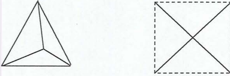
Şekil 4.1 Koordinasyon sayısı dört olan yapılar için tetrahedron ve kare düzlem geometrileri
