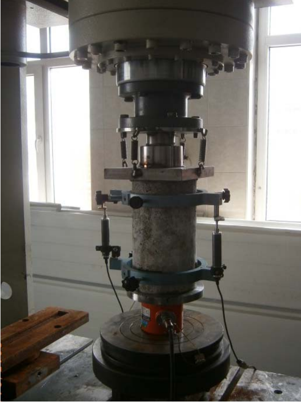
Şekil 3. Basınç test düzeneği ve ölçüm sistemi (Compression test setup and measurement system)
