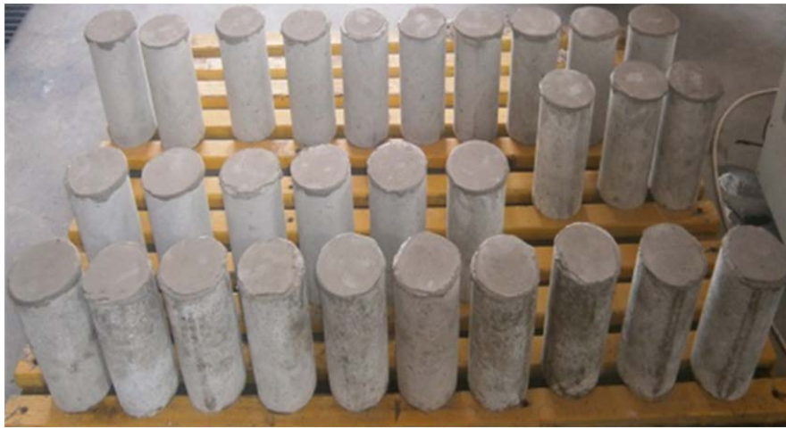
Şekil 2. Test edilecek beton numuneleri (Concrete specimens for testing)
