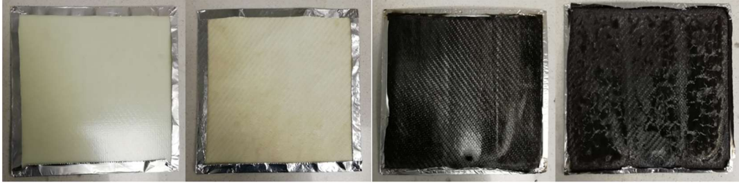
Şekil 4.12. Soldan sağa sırasıyla; %20 IFR36 içeren test öncesi, %20 IFR36 +Antibakteriyel işlem görmüş test öncesi, %20 IFR36 içeren test sonrası, %20 IFR36 +antibakteriyel işlem görmüş test sonrası numunelerinin görselleri
