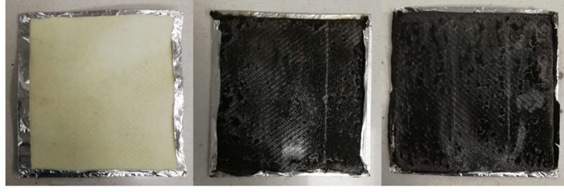
Şekil 4.7. Soldan sağa sırasıyla; %15 AP750 +Antibakteriyel işlem görmüş test öncesi, %15 AP750 içeren test sonrası, %15 AP750+antibakteriyel işlem görmüş test sonrası numunelerinin görselleri
