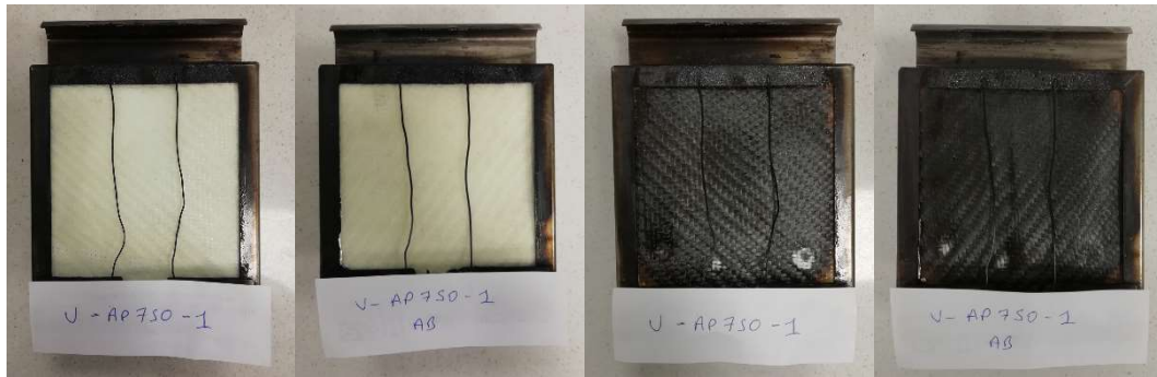
Şekil 4.4. %5 AP750 ve antibakteriyel malzeme ilaveli %5 AP750 katkılı numunelerin yanma öncesi ve sonrası görselleri.
