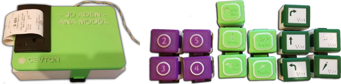
Görsel 2.2. Sol tarafta 3D ADEN Donanımının ana modülüne, sağ tarafta ise sırasıyla sayı modülleri, temel modüller ve şart modüllerine ait görseller.
