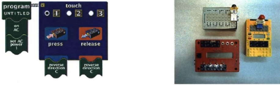
Görsel 1.4. Örnek bir RCX yapısı (solda) ve Programlanabilir Tuğla'ların çeşitli versiyonları (sağda) (McNerney, 2000)
