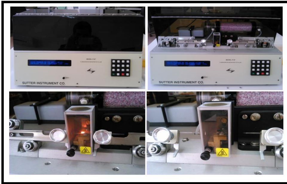
Şekil 2. 7 Pipet yapıcı puller [17]
