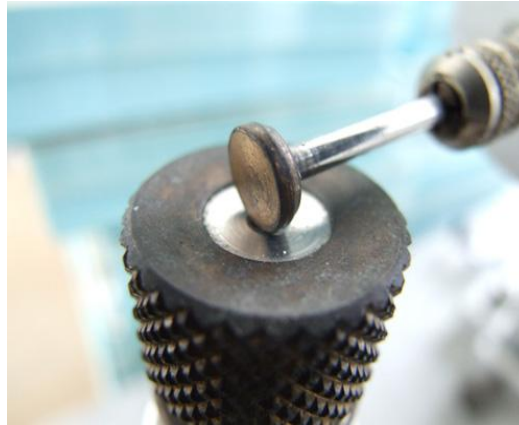
Şekil 4.18. Çukur oluşturma cihazında numunenin konduğu ve inceltmenin olduğu bölüm [30]
