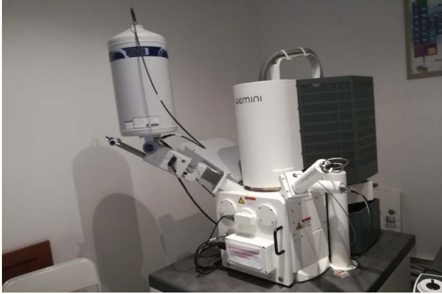
Görsel 2.3. Gemini ZEISS Supra 50 VP SEM cihazı
