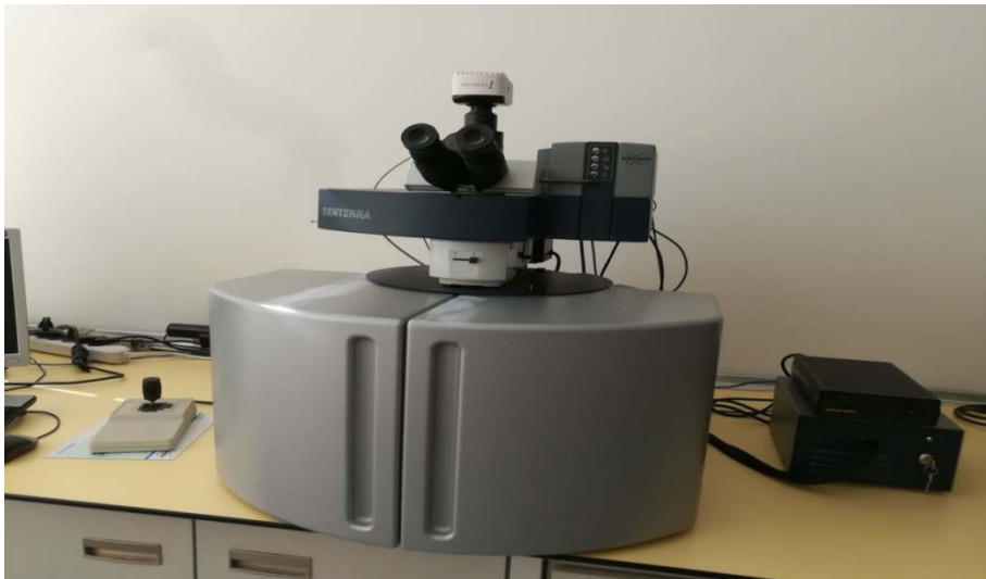
Görsel 2.2. Senterra Dispersive Raman Spectrometer cihazı
