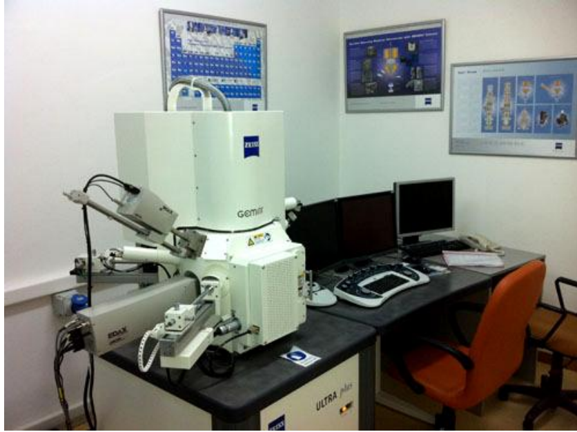
Őekil 4.7. ZEISS ULTRAPLUS marka FESEM (Field Emission Scanning Electron Microscopy) cihazının fotođrafı
