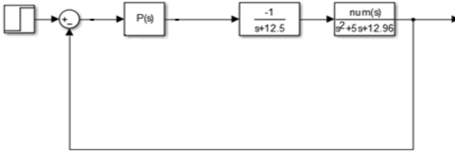
Şekil 4.2. P denetleyicili kontrol sistemi
