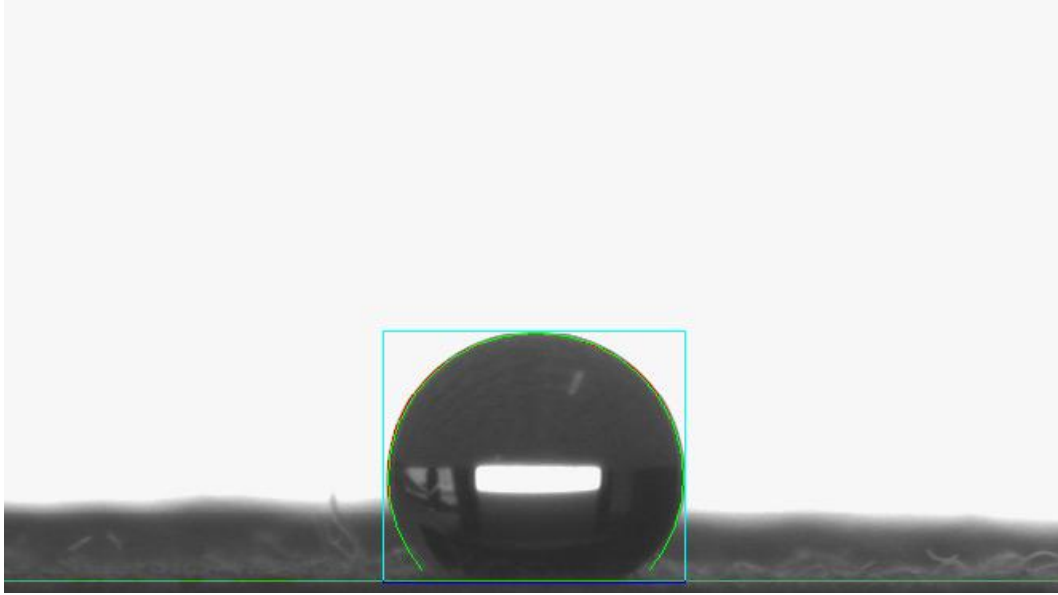
Şekil 6.14. Apre kimyasalı uygulanmış Pes-Vis kumaş örneğinin su iticilik temas ölçümü (30sn)
