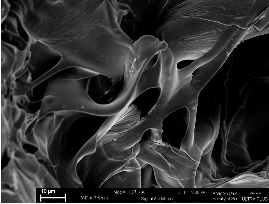
Şekil 3.1. Farklı büyütme oranlarında P(HEMA) kriyojel SEM görüntüleri A) 100X; B)200X; C)500X; D)1007 X
