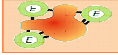
Şekil 2.8. Kovalent bağlanma ile immobilizasyon (Bickerstaff 1997)
