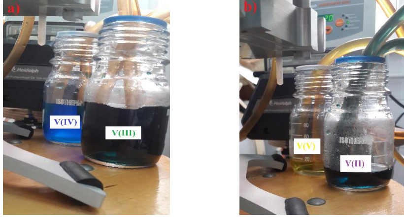
Şekil 3.9. a) Şarj edilmemiş pozitif ve negatif elektrolit çözeltileri b) Tam şarjda pozitif ve negatif elektrolit çözeltileri
