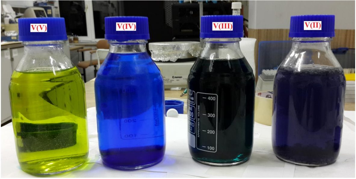
Şekil 1.2. Vanadyum iyonunun farklı yükseltgenme basamaklarındaki renk değişimleri
