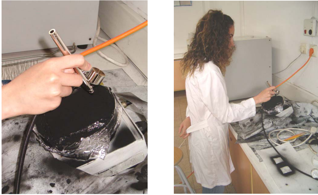
Şekil 8.6. Teflonlanmış karbon kumaş üzerine karbon süspansiyonun hava fırçasıyla püskürtülmesi
