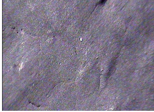
Şekil 8.8. Yeni yöntemle hazırlanan karbon tozu kaplı karbon kumaşın optik mikroskop görüntüsü
