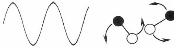
Şekil 4.1. Salınım yapan elektrik alanla sıralanmaya yönelen dipolar moleküller
