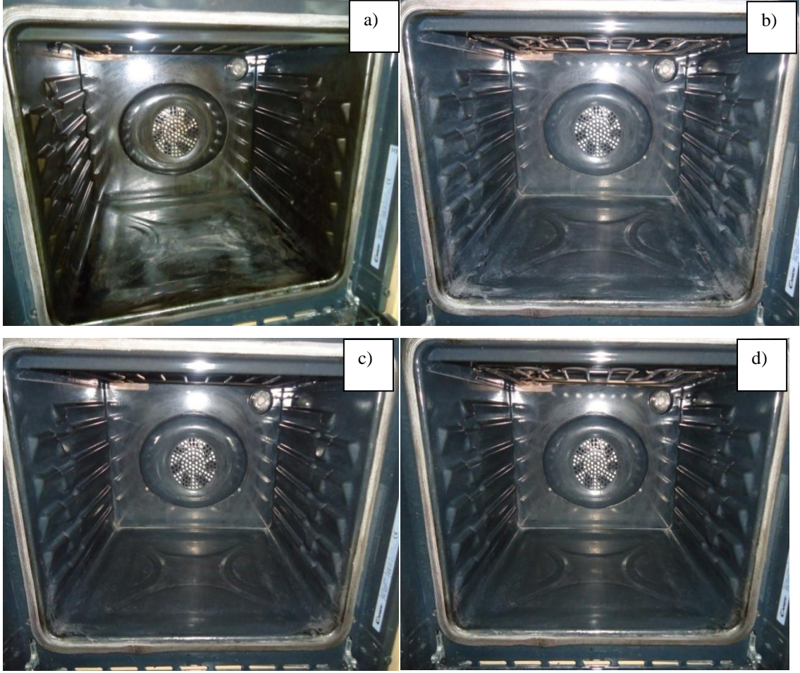
Şekil 9.16. Isıtma programı 12'ye göre pirolitik fırın a) Kirletilmiş hali, b) Pirolitik çevrim sonrası c) 2. pirolitik çevrim sonrası, d) 3. pirolitik çevrim sonrası.
