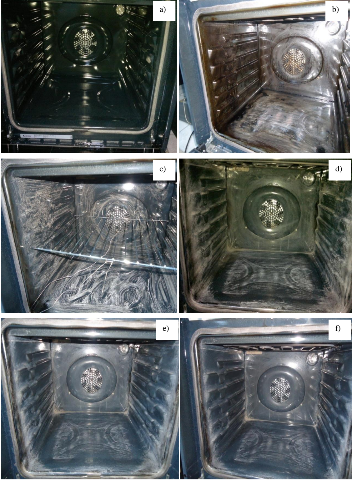
Şekil 9.3. Hoover marka pirolitik fırın a) Pirolitik çevrim öncesi, b) Kirlilik oluşturulması, c) Pirolitik çevrim sonrası, d) Pirolitik çevrim sonrası manuel temizleme, e) 2. pirolitik çevrim sonrası manuel temizleme, f) 3. pirolitik çevrim sonrası manuel temizleme.
