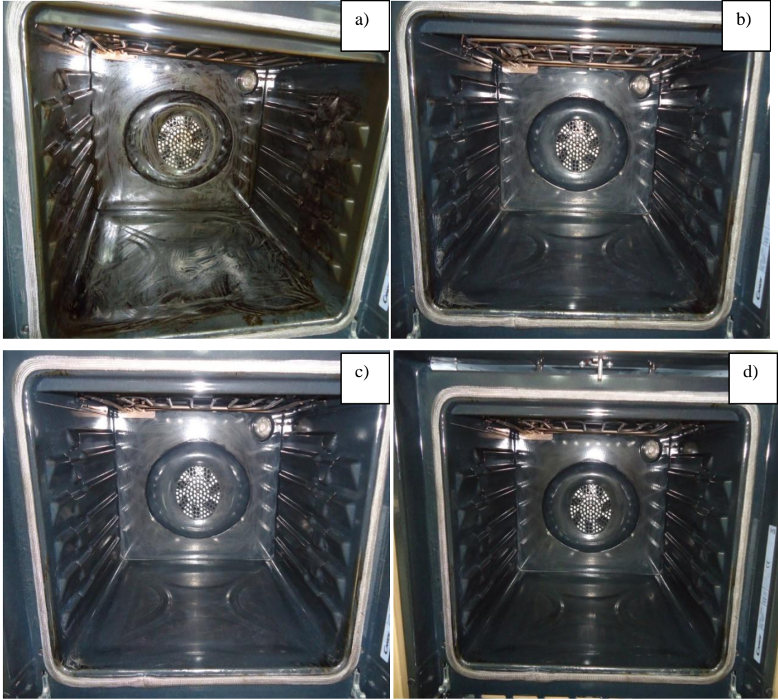
Şekil 9.15. Isıtma programı 10’a göre pirolitik fırın a) Kirletilmiş hali, b) Pirolitik çevrim sonrası c) 2. pirolitik çevrim sonrası, d) 3. pirolitik çevrim sonrası.
