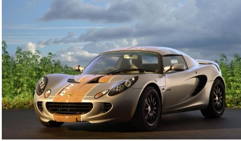
Görsel 2.4. Lotus Firmasının 2008 Yılında Temmuz Ayında Piyasaya Sürdüğü Gövde Paneli, Hava Freni ve Koltukları Doğal Liflerden Yapılmış Olan Eco Elise Konsept Aracı [11]
