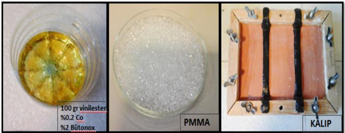
Görsel 2.2. BNNS katkılı PMMA'nın vinil ester ile karışımı prosesi
