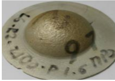
Görsel 3. 3. Mg-2Zn-2Ce alaşımının 450 °C 16 bar basınçta yapılan serbest şişme testi numunesi görüntüsü
