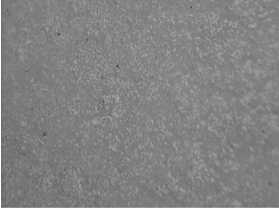
Şekil 7.16. 0.06 ml/dk akış hızında kaplanmış numunenin stereo mikroskop görüntüsü
