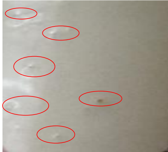
Şekil 6.49. 1250°C - 830 dak. rejiminde pişirilmiş T1011'da gözlemlenen kabarcıklanma hatası (kabarcıklar elips içinde gösterilmiştir)
