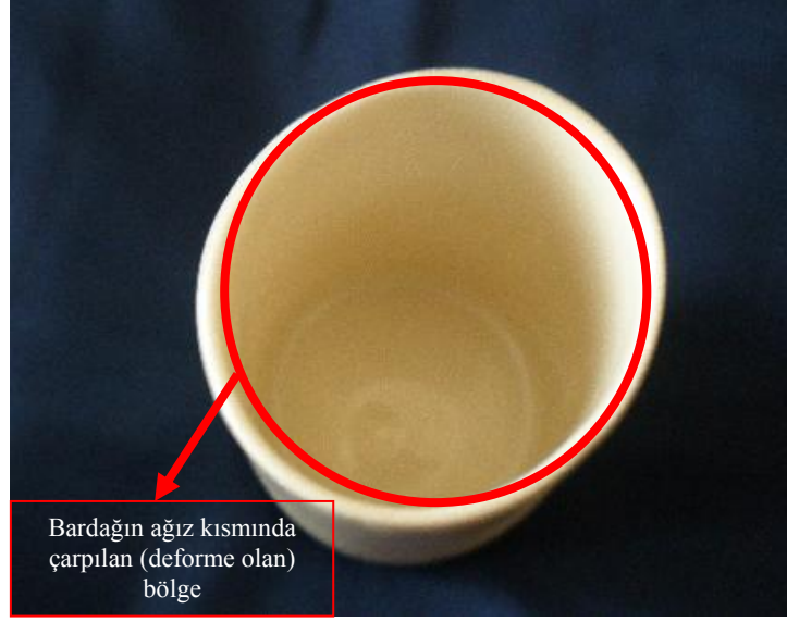
Şekil 6.55. T1011 kodlu numunenin 1250 °C/830 dakika rejiminde gösterdiği deformasyon sonucu bardağın ağız kısmında meydana gelen şekil bozukluğu
