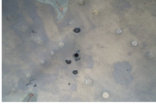
Şekil 2.5 Bir uçağın dış yüzeyindeki perçinlerde oluşmuş çatlak korozyonu [6]
