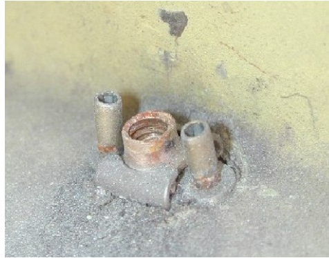
Şekil 2.3 ES-3B Viking uçağının yatay kuyruk bölgesi üzerinde galvanik korozyon [5]
