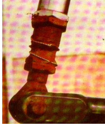
Şekil 6.2 İniş takımı ayar rotlarında oluşan uniform korozyon [4]
