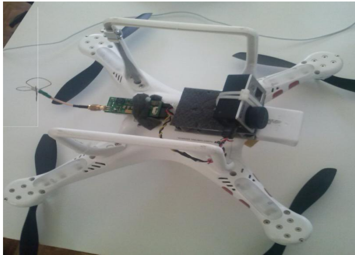
Şekil 4.10. İHA üzerine yerleştirilmiş video vericisi ve anteni
