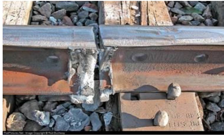
Şekil 3.16. Kırık kaynak noktası [31]
