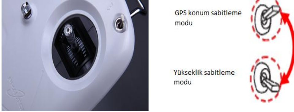
Şekil 4.2. Kumanda üzerinde bulunan pozisyon ve yükseklik sabitleme anahtarları ve konumları [32]
