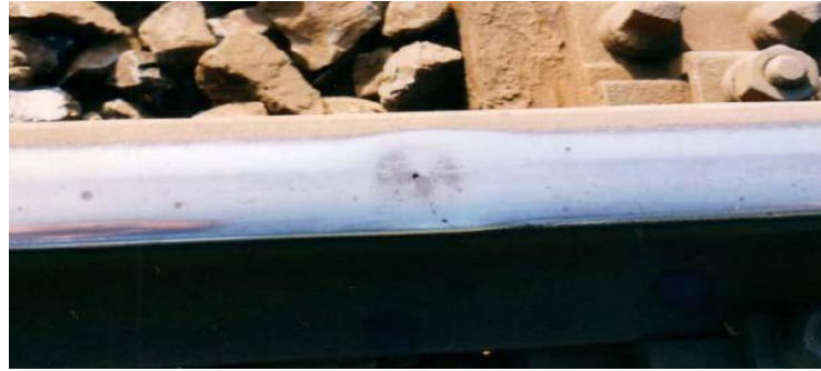
Şekil 3.14. Ray üzerinde oluşan ezilme [27]
