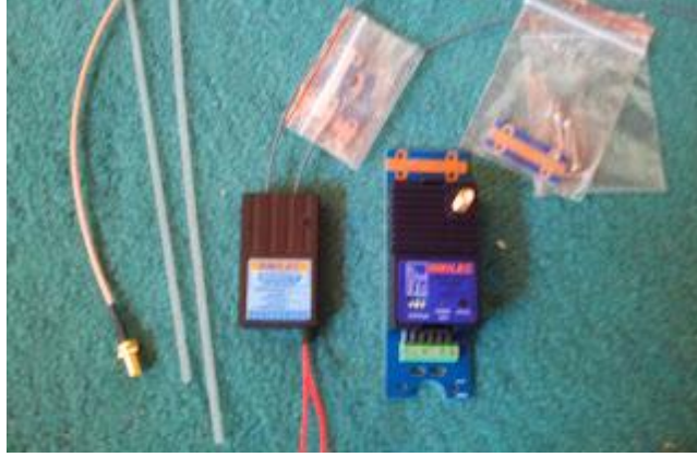
Şekil 5.1. 60 km menzilli Alıcı – Verici ünitesi
