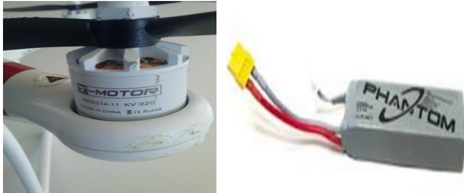
Şekil 4.8. Fırçasız doğru akım motoru ve 3 hücreli batarya
