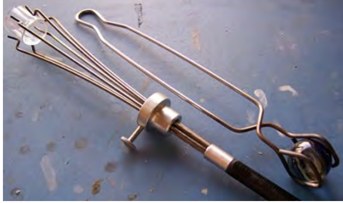
Görsel 3.11. Cam Tutucu – Hotfinger.
