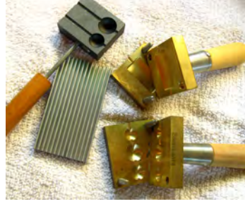
Görsel 3.7. Pirinç, alüminyum, grafit kalıplar.
