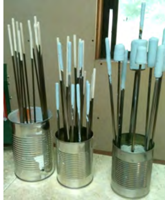
Görsel 3.8. Boncuk ayırıcı sürülmüş çelik çubuklar.
