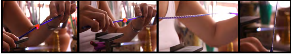
Görsel 4.3. İki veya daha fazla renkle burğu şeklinde ince çubuk oluşturmak.
