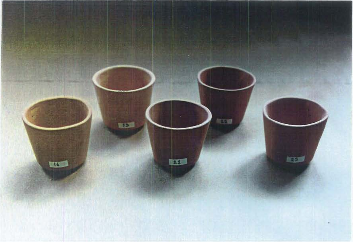
Resim 8: Kırmızı-Yeşil Killer İle Yapılan Döküm Çamuru Numuneleri
