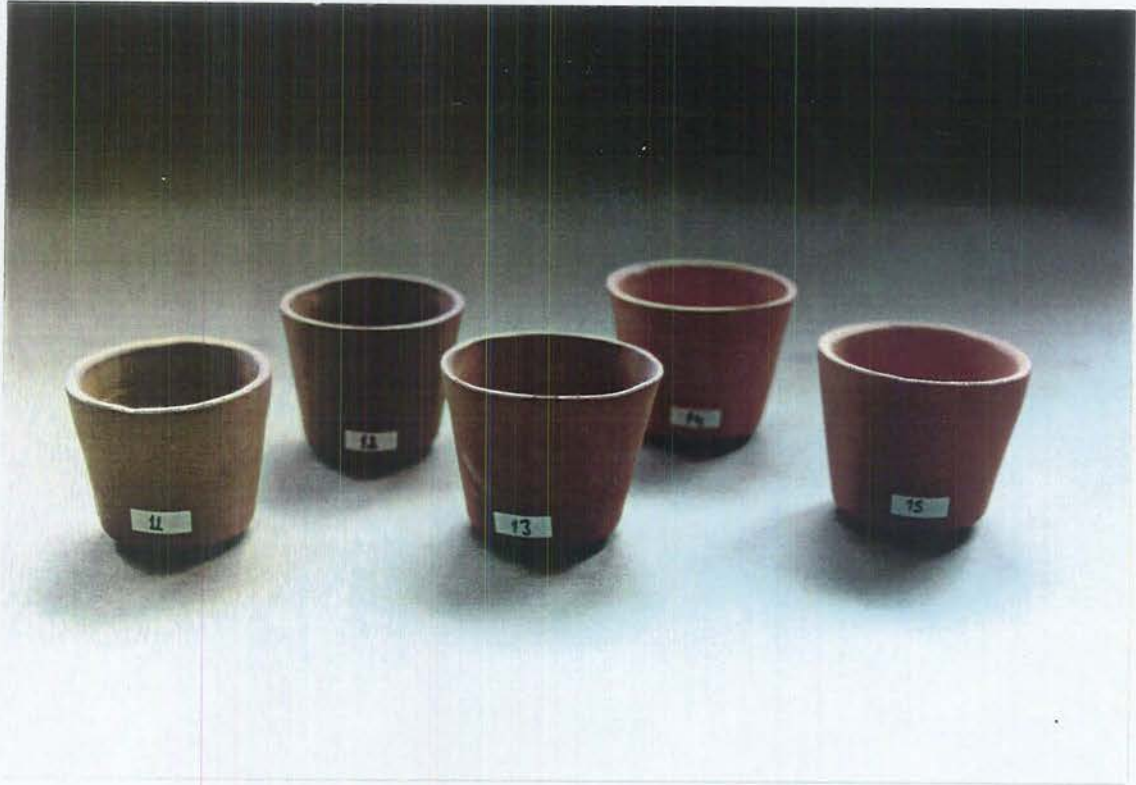
Resim 7: Kırmızı-Yeşil Killer İle Yapılan Döküm Çamuru Numuneleri
