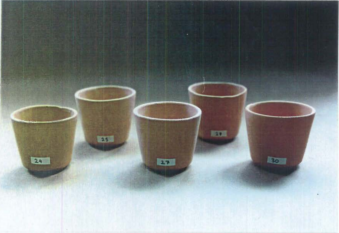
Resim 9: Kırmızı-Yeşil Killer İle Yapılan Döküm Çamuru Numuneleri
