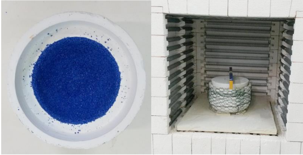
Görsel 4.3. Kalıp İçine Granül Camın Sabitlenmesi ve Kalıbın Fırına Yerleştirilmesi Kaynak: Nihal Turan, 2017
