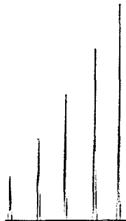
Şekil 4.1.3.1. Mitomisin C' nin 2 \times 10^{-6} - 1 \times 10^{-5} M derişim aralığındaki çözeltilerinin 1 mL/dk akış hızında ve 363 nm' deki sinyalleri.
