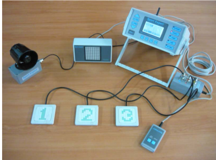
Şekil 8. Reaksiyon Zamanı Ölçüm Seti
