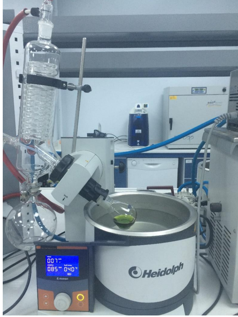
Görsel 2.5. Ekstrelerin Rotavapor'da Çözücüden Uzaklaştırılması
