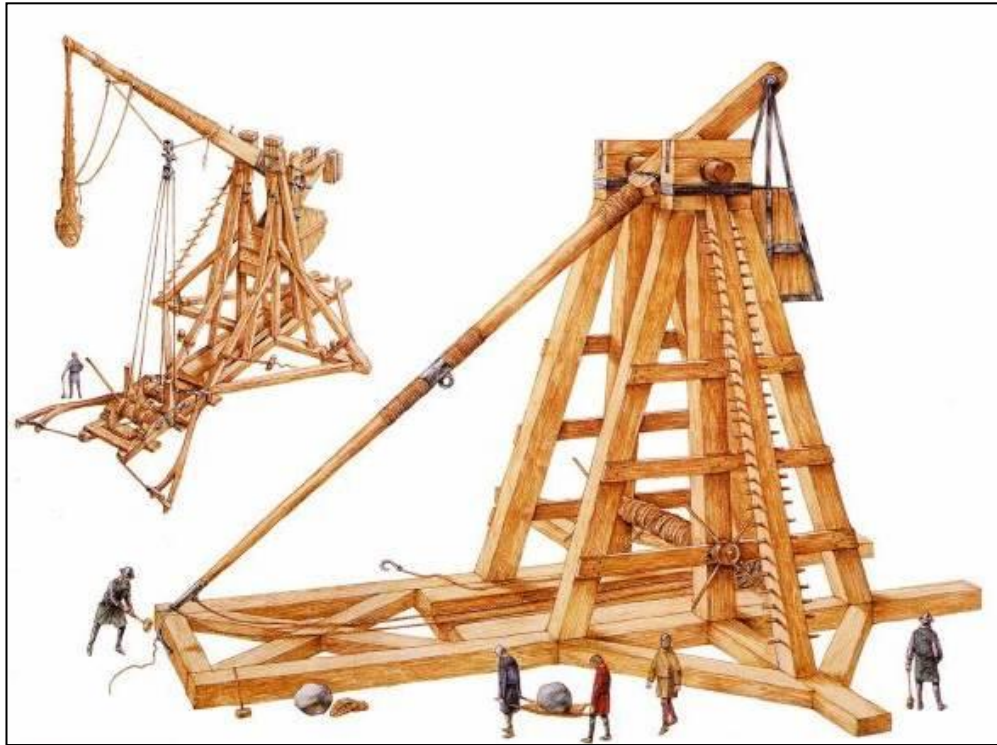
Levha 21.a. Karşı ağırlıklı mancınık çizimi (Gravvet, 1990, Fig. F)
