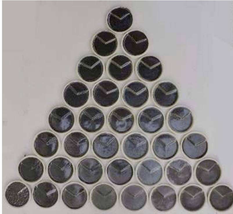
Görsel 7. Üçlü sır diyagramına göre hazırlanan aventurin sırlar, 1200°C
