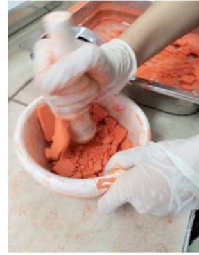
Görsel 5. Sırların havanda öğütülmesi
