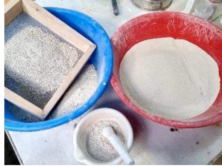
Görsel 2. Kurutulan boraks atığının öğütülmesi ve elenmesi
