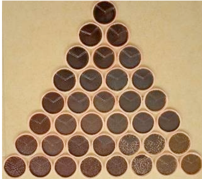
Görsel 6. Üçlü sır diyagramına göre hazırlanan aventurin sırlar, 1000°C
