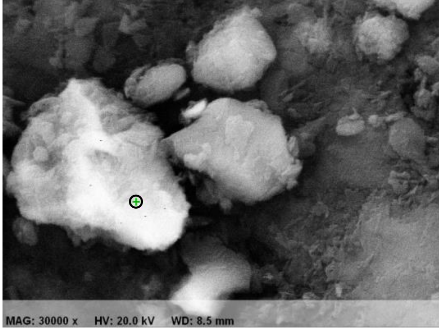
Şekil 3. Manyetik modifiye Gördes zeolitinin SEM fotoğrafı
