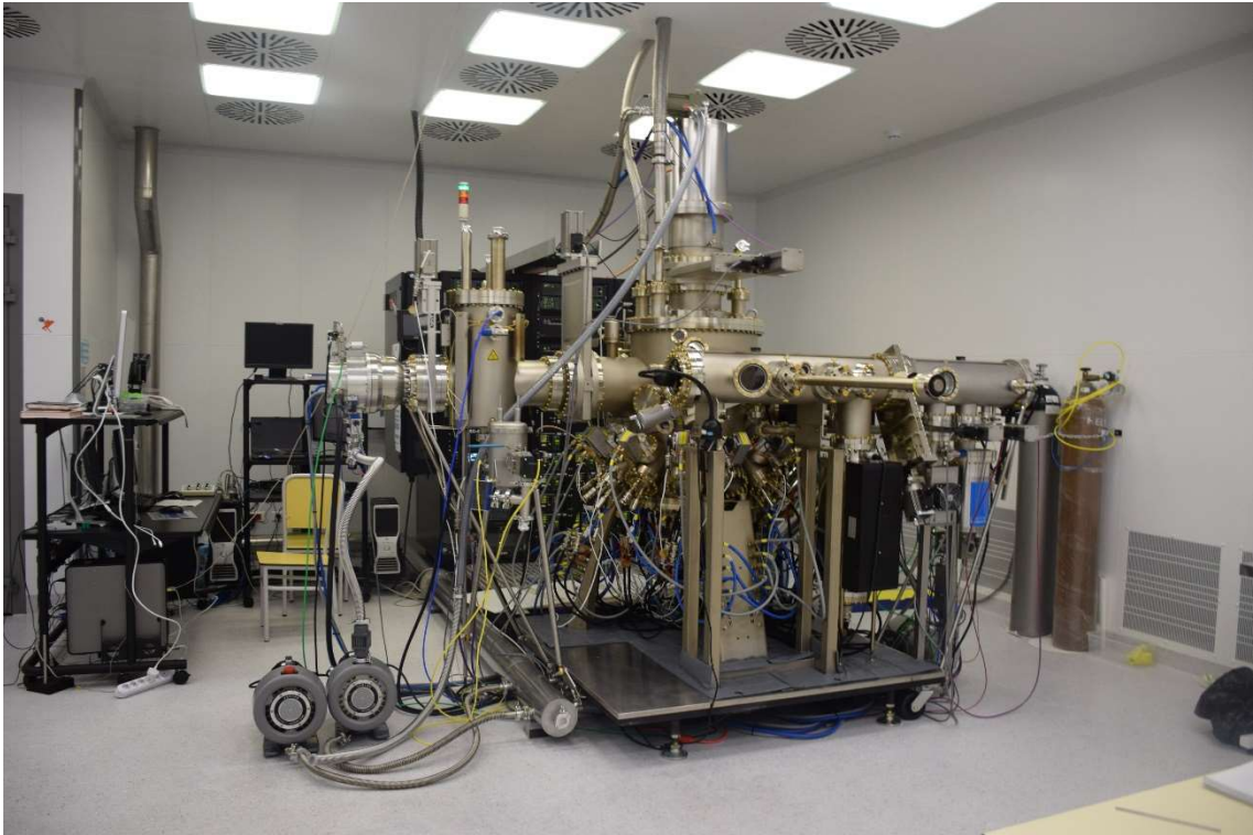
Görsel 3.1. MBE sistemi, Nanoboyut Araştırma Laboratuvarı
