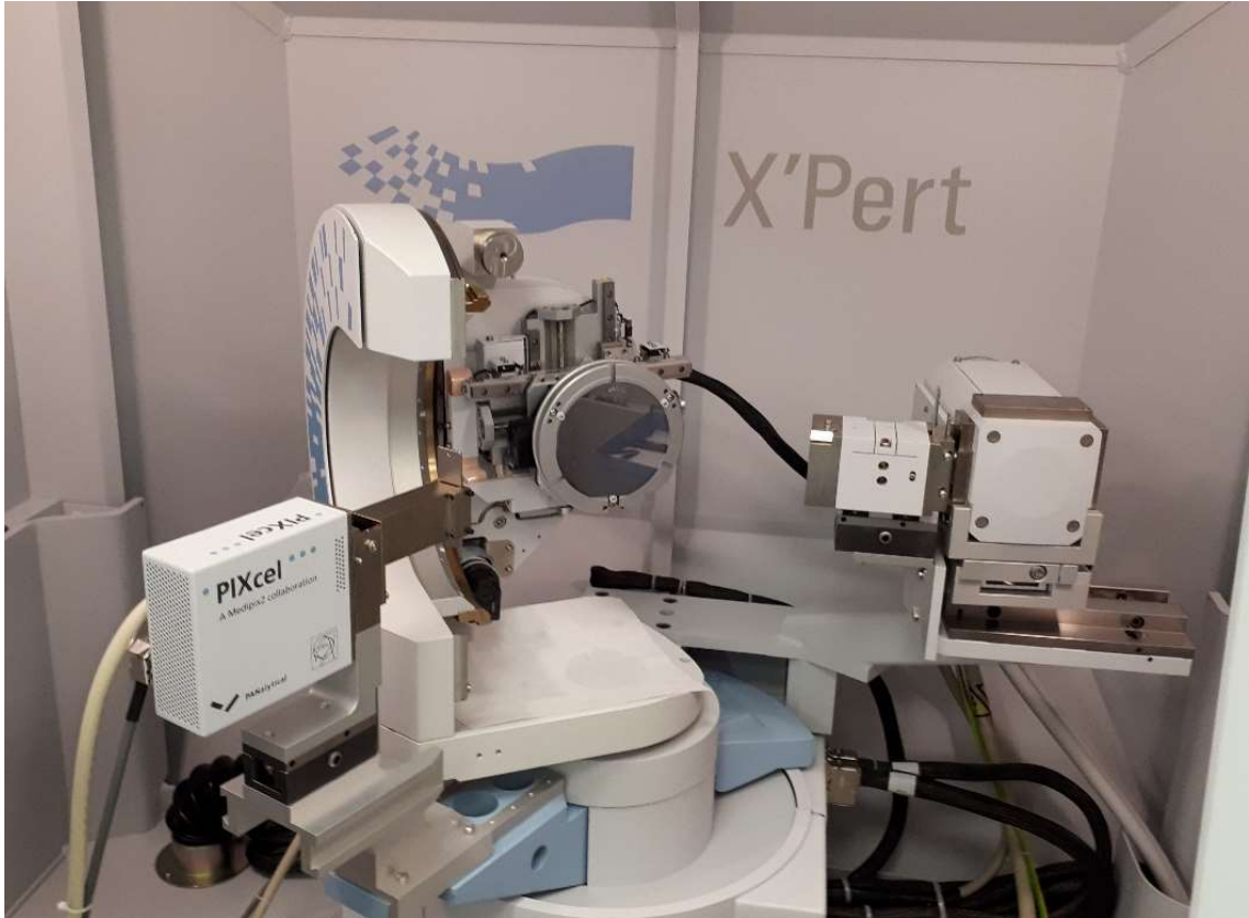
Görsel 3.2. HRXRD cihazı, Nanoboyut Araştırma Laboratuvarı
